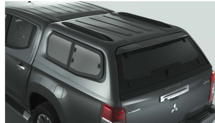
Zabudowa premium z bocznymi szybami uchylnymi, tylko DC
